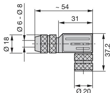
Fig. 12-7: Connector type BKS-S136M-00
